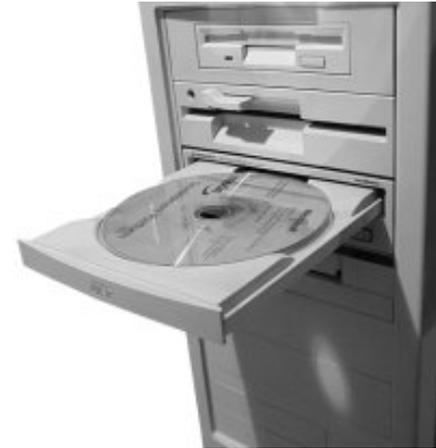
I CD sono costituiti da un disco in lega metallica del diametro di 5,25", racchiuso da uno strato trasparente (per preservare la superficie interna da graffi), sul quale vi sono delle depressioni impresse a forma di spirale in fase di registrazione da un **raggio (Beam) Laser**; ogni depressione corrisponde ad un singolo bit.
